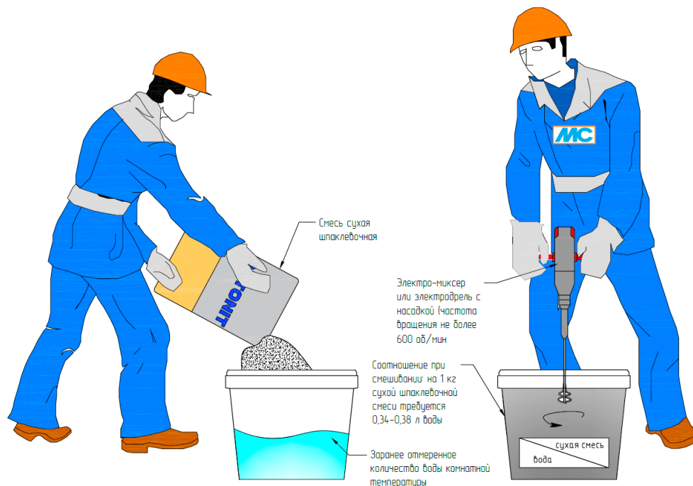
Рис. 28. Организация работ по затворению сухой шпаклевочной смеси
